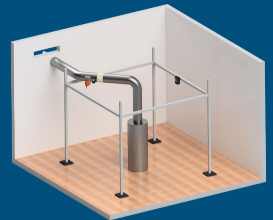
Versuchsaufbau: - Raumgröße: 30,3 m 3 - Luftwechsel (bei 100 % Leistung): 11
