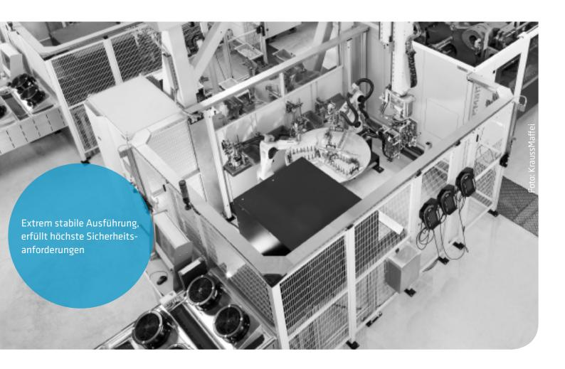
ProSafe wurde mit seinem extrem stabilen und soliden Design für anspruchsvolle Industrieumgebungen entwickelt. Die Elemente des Systems bieten eine sehr hohe Stabilität.
